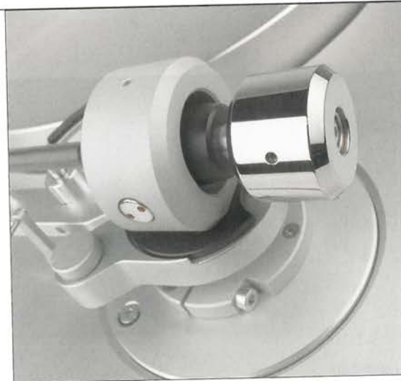
Der Tonarm ist ein kardanisch gelagertes Modell mit gut neun Zoll effektiver Länge
