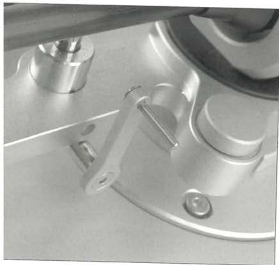
Die „Kurbel“ ist ein Lifthebel der etwas anderen Art – sehr gelungen
